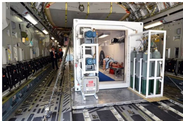
图3 为应对埃博拉病毒设计的集装箱生化隔离系统 ③
