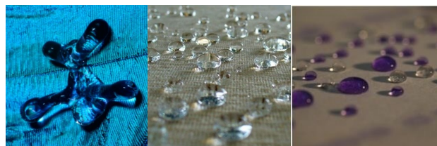
图8 具有细小格栅型质感表面的疏水材料
