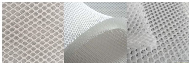
图24 三维透气弹性织物
