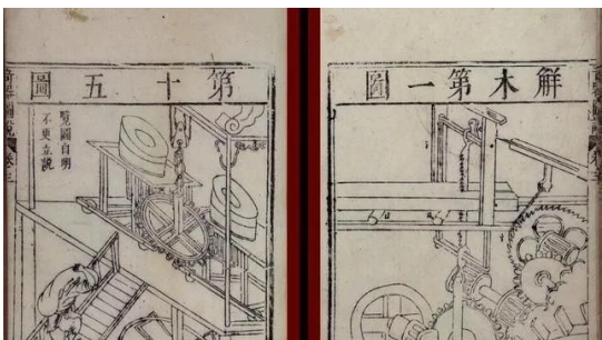
图5 水力驱动锯(来源于《新制诸器图说》中解木)
